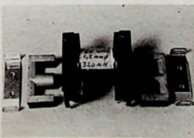
Afb. 14 Met 50 windingen van geëmailleerd koperdraad met een doorsnede van 1,2 mm bewikkeld.
